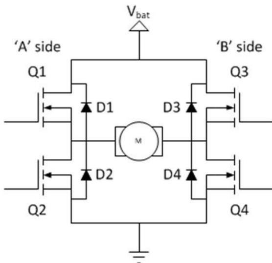
**FIGURE 2. TYPICAL H-BRIDGE CIRCUITRY**
