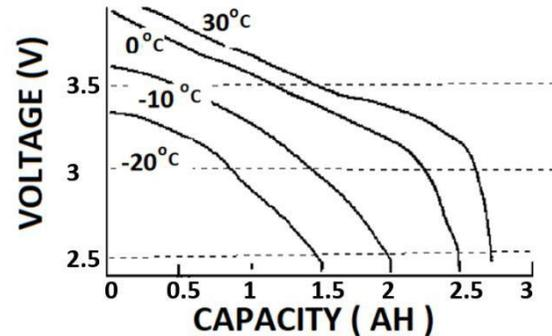
**FIG. 1 BATTERY VOLTAGE VERSUS CAPACITY AT VARIOUS TEMPRATURES**
