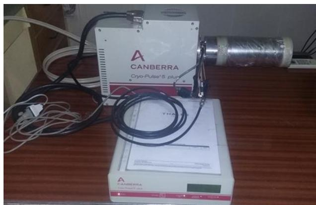
**Fig. 1:** Cryo-Pulse<sup>®</sup>5 HPGe detector.
