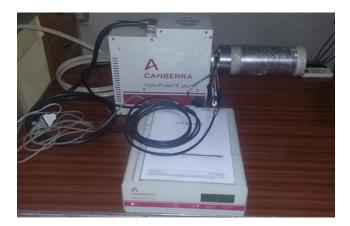
Fig. 1: Cryo-Pulse<sup>®</sup>5 HPGe detector.
