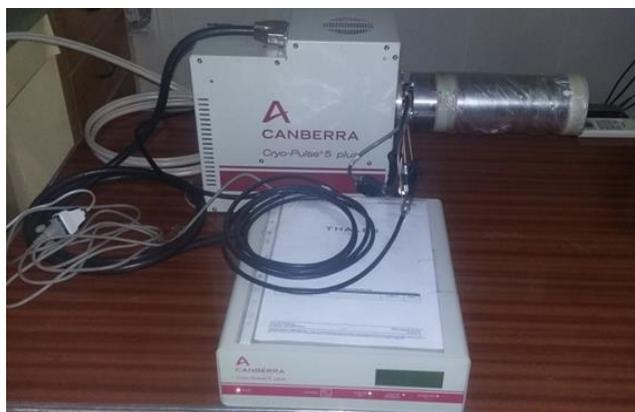
**Fig. 1:** Cryo-Pulse<sup>®</sup>5 HPGe detector.
