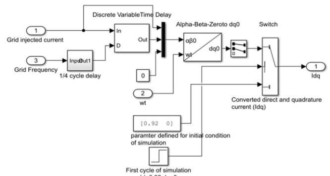
Figure 3: dq transformation for current
