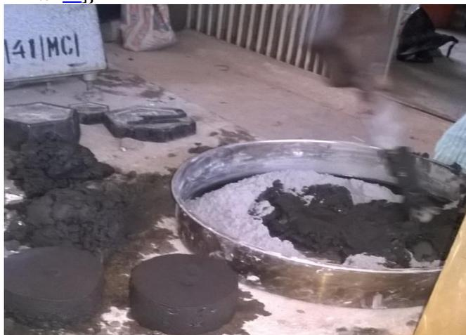
Plate VIII: SPECIMEN FOR TESTING THE LBWA SETTING TIME
