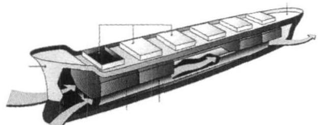
图 1 无压载水舱货船的示意图
