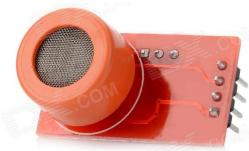
Fig. 3.1 MQ-3 Sensor
